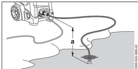
Чтобы обеспечить засасывание воды, разность по высоте между мойкой высокого давления и источником воды не должна превышать максимальную высоту всасывания (а),
