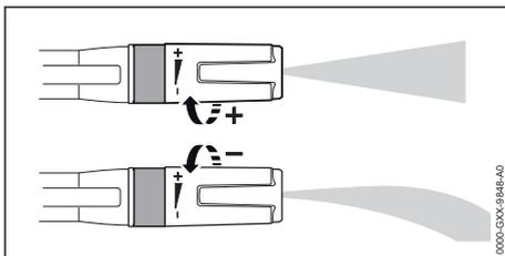
Возможна регулировка плоскоструйной насадки.
