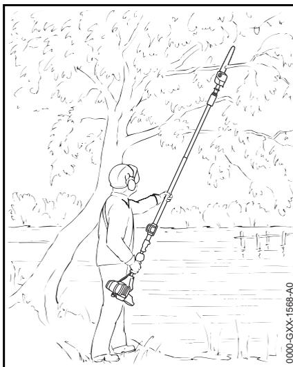
Благодаря большому радиусу действия можно обрезать сучья над препятствиями, такими как, например, водоёмы. Угол установки зависит от положения сучка.
