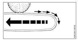
При пилении верхней стороной направляющей шины мотопила может быть отброшена в направлении пользователя.
