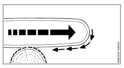
При пилении нижней стороной направляющей шины мотопила может быть затянута в сторону.
