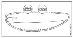
Уложить пильную цепь в паз направляющей шины так, чтобы стрелки на соединительных звеньях пильной цепи с верхней стороны были сориентированы в направлении движения.
