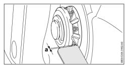
Измерить следы приработки на звездочке с помощью контрольного шаблона STIHL.  Если следы приработки имеют глубину больше а = 0,5 мм: не использовать мотопилу и обратиться к дилеру STIHL.
