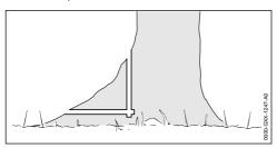
При наличии на стволе корневых наплывов: подпилить корневые наплывы сначала горизонтально, затем вертикально, после чего удалить.
