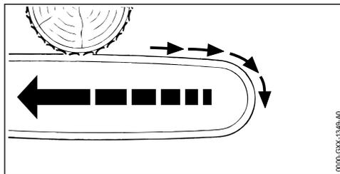
При пилении верхней стороной направляющей шины мотопила может быть отброшена в направлении пользователя.
