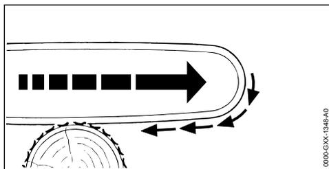
При пилении нижней стороной направляющей шины мотопила может быть затянута в сторону.
