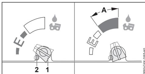
Когда регулировочный винт масляного насоса (1) находится в положении E (Ematic), расход масла является оптимальным для большинства применений.
