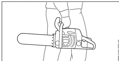
После работы двигателя возможен сильный нагрев глушителя и двигателя. Возможны ожоги пользователя.
