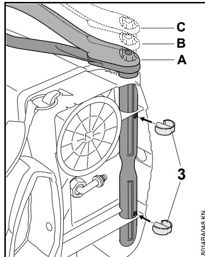
Рычаг можно отрегулировать по ширине корпуса пользователя.
