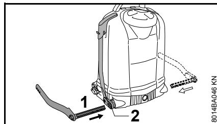
Рычаг может монтироваться на устройстве слева или справа.
