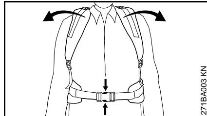
На случай аварийной ситуации: потренировать быстрое открывание замка на набедренном пояске (только SG 71), освобождение наплечных лямок и снимание агрегата со спины. При тренировке агрегат не бросать на землю, чтобы избежать повреждений.
