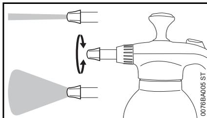
Характер распыления (сфокусированная струя или мелкое распыление) может регулироваться вращением насадки.
