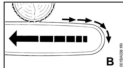
Если при пилении верхней стороной направляющей шины – обратный пропил – пильная цепь защемляется или наталкивается на твердый предмет в древесине, то пила может быть отброшена в сторону пользователя – **во избежание этого:**
