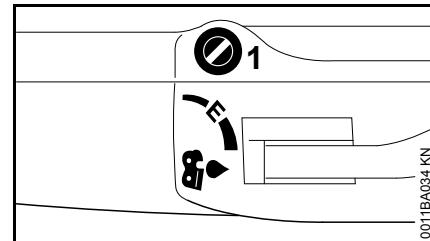
Подача смазочного масла может регулироваться в зависимости от потребности с помощью регулировочного болта (1) на верхней стороне агрегата
