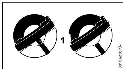
слева: Нижняя часть крышки бака перекручена – расположенная внутри маркировка (1) совпадает с внешней маркировкой
