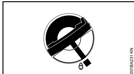
В этом случае маркировки на запорном устройстве бака и на топливном баке будут совпадать
