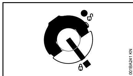
Запорное устройство бака зафиксировано
