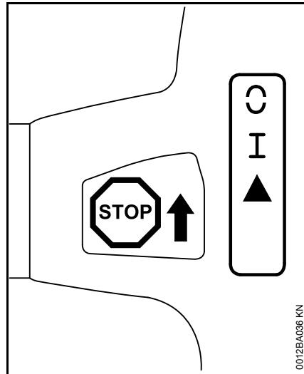
СТОП или С – для выключения зажигания комбинированный рычаг необходимо отжать в направлении СТОП или С . После отпускания комбинированный рычаг отпружинивает обратно в рабочее положение I .
