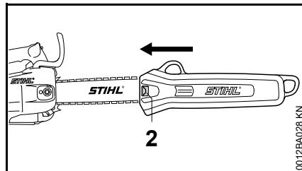
Захисту цепі всегда одевати на направляющую шину до упора. Фиксирующий выступ (2) должен фиксироваться на крышке цепной звёздочки.
