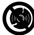
Чаще проверять абразивно-отрезной круг – абразивно-отрезной круг немедленно заменить, если обнаружены трещины, искривления или другие повреждения (например, перегрев) – при повреждении существует **опасность несчастного случая!**
