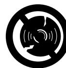
Чаще проверять абразивно-отрезной круг – немедленно заменить абразивно-отрезной круг, если обнаружены трещины, деформации или другие повреждения (например, перегрев) – при поломке существует опасность несчастного случая!
