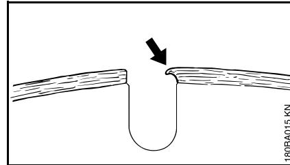
При продолжении работы затупившимися сегментами последние могут размягчиться, вследствие значительного тепловыделения – основное полотно раскаляется и теряет свою твердость – это может привести к деформациям, явно распознаваемым по качению абразивно-отрезного круга.
