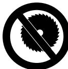
Запрещается применять пильные диски, твердосплавные, спасательные, дереворежущие или иные зубчатые инструменты – **опасность получения смертельных травм!** В противоположность равномерному съему частиц при эксплуатации абразивно-отрезных кругов, зубья пильного диска с долотообразными зубьями при резке могут застрять в материале. Это способствует агрессивной резке, что может привести к возникновению неконтролируемых, чрезвычайно опасных реактивных сил (обратный удар) устройства.
