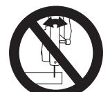
Абразивно-отрезной круг вводить в разрез прямо, не перекаивать и не подвергать боковой нагрузке.
