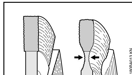
При резке дорожного полотна не следует проникать в несущий слой (часто щебень) – при этом может
