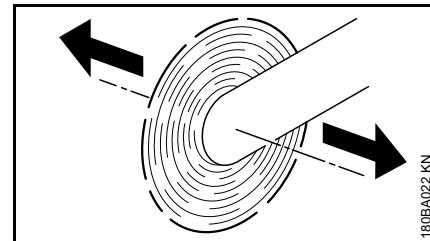
Если абразивно-отрезное устройство при вращающемся абразивно-отрезном круге перемещается в направлении, указанном стрелкой, возникает сила с опрокидывающим воздействием на устройство.
