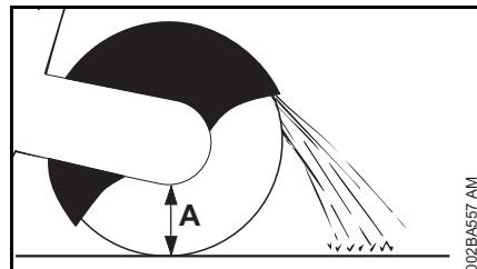
Образ действия зависит от наружного диаметра трубы и максимально возможной глубины резания абразивно-отрезного круга (A).
