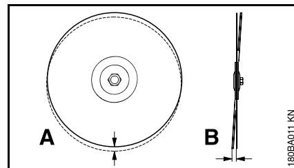
Чрезмерное отклонение от допуска на радиальное биение (A) перегружает отдельные алмазные сегменты, которые, при этом, нагреваются. Это может вызвать возникновение трещин в основном полотне или расплавление отдельных сегментов.
