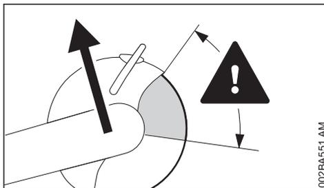
При обратной отдаче абразивно-отрезное устройство внезапно отбрасывается в сторону пользователя, выходя из-под контроля.
