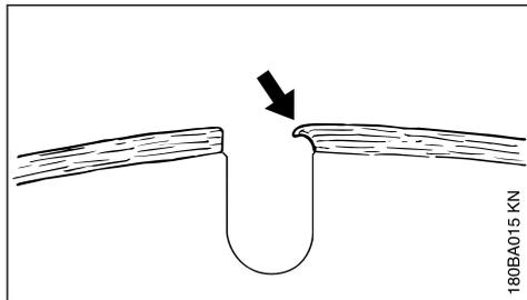
При продолжении работы затупившимися сегментами последние могут размягчиться, вследствие значительного тепловыделения – основное полотно раскаляется и теряет свою твердость – это может привести к деформациям, явно распознаваемым по качению абразивно-отрезного круга. Прекратите эксплуатацию абразивно-отрезного круга – **опасность несчастного случая!**
