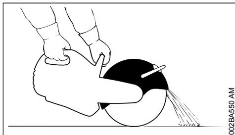
Правильно отрегулировать защиту абразивно-отрезного круга: частицы снимаемого материала должны отводиться в сторону от пользователя и устройства.
