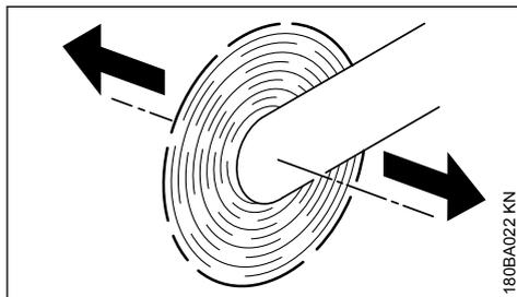
Если абразивно-отрезное устройство при вращающемся абразивно-отрезном круге перемещается в направлении, указанном стрелкой, возникает сила с опрокидывающим воздействием на устройство.
