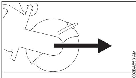
Если абразивно-отрезной круг касается разрезаемого предмета сверху, то абразивно-отрезное устройство оттягивается от пользователя вперед.
