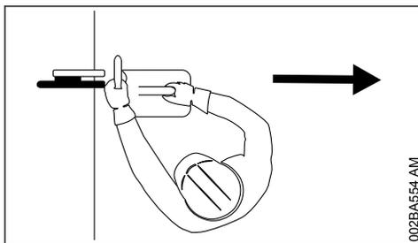
Следить за тем, чтобы в расширенный диапазон поворота абразивно-отрезного круга не попали части тела. Должно быть обеспечено достаточное свободное пространство, в особенности требуется достаточно места для работы в котлованах и на случай падения отрезанной части.
